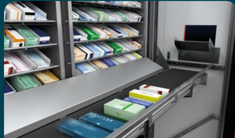
Tras la solicitud, los medicamentos se deslizan sobre la cinta transportadora de recogida bidireccional - Ultra-Multipick-Sistema de entrega.
