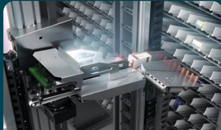
Transferencia de los medicamentos desde la pinza del sistema al portal de almacenamiento totalmente automático del RAPID.
