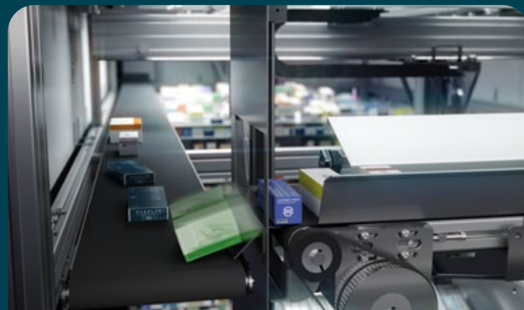
Los medicamentos se transportan al sistema de transporte conectado o directamente al dispensador a través de la cinta colectora bidireccional de altura regulable.
