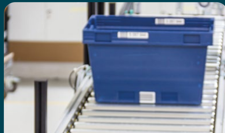
La preparación de pedidos específicos puede realizarse en cajas de recogida con un sistema de transporte de rodillos conectado.
